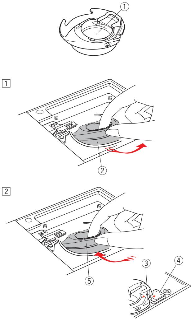
Замените стандартный шпулодержатель на шпулодержатель для вышивки (высокое натяжение), когда вы используете шпульную нить отличную от игольной нити для вышивки.
