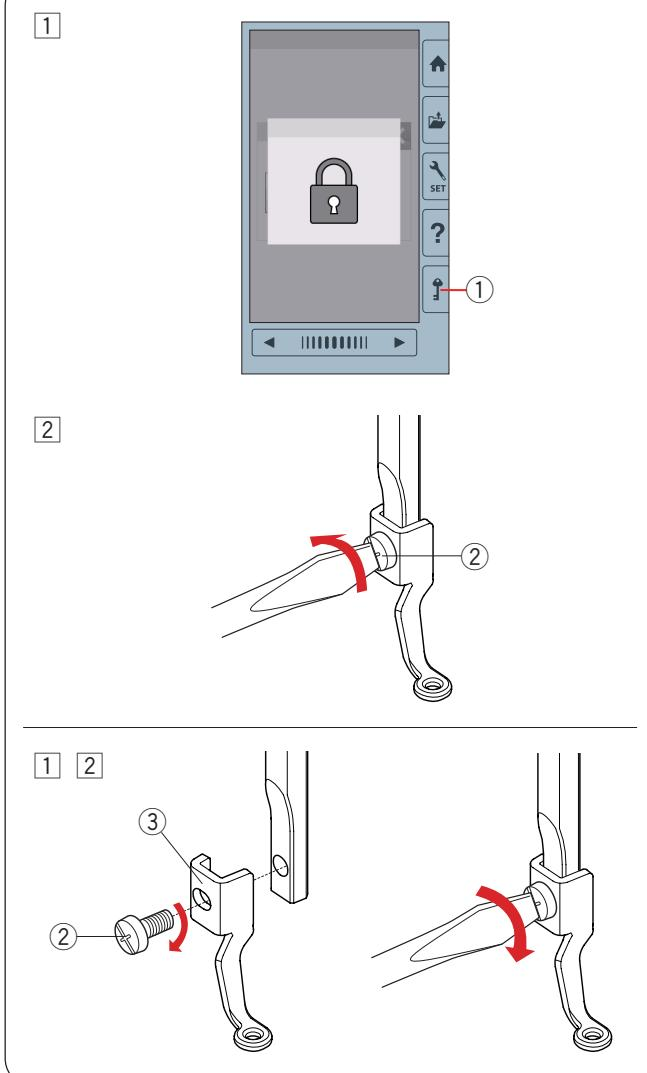
Снимите вышивальную лапку, когда снимаете игольную пластину для обслуживания машины и т.п.
